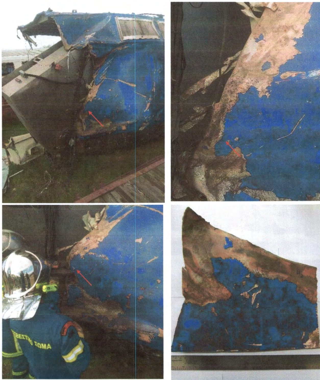
Εικόνα 6: Δείγμα "H2" (Ηλεκτράμαξα 2), από το πίσω και δεξιά τμήμα της αποκόλλησης
