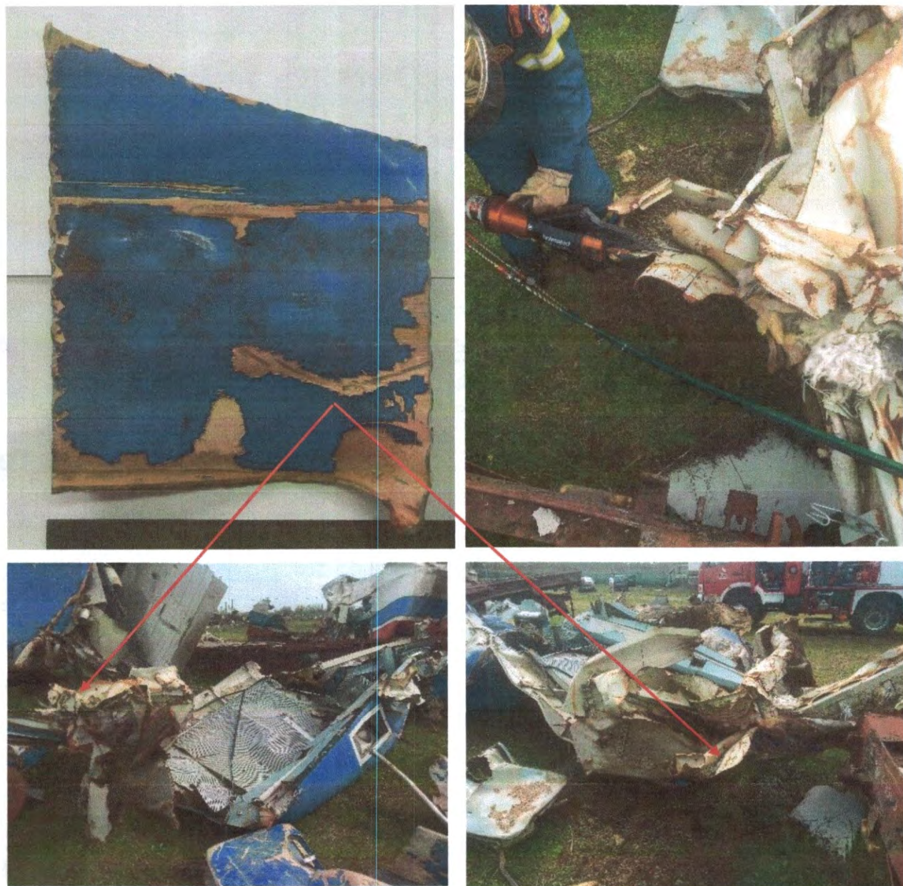
Εικόνα 8: Δείγμα “Κ1β” (Κόκπιτ 1β) από την δεξιά πλευρά της οροφής του Θαλάμου Μηχανοδότησης
