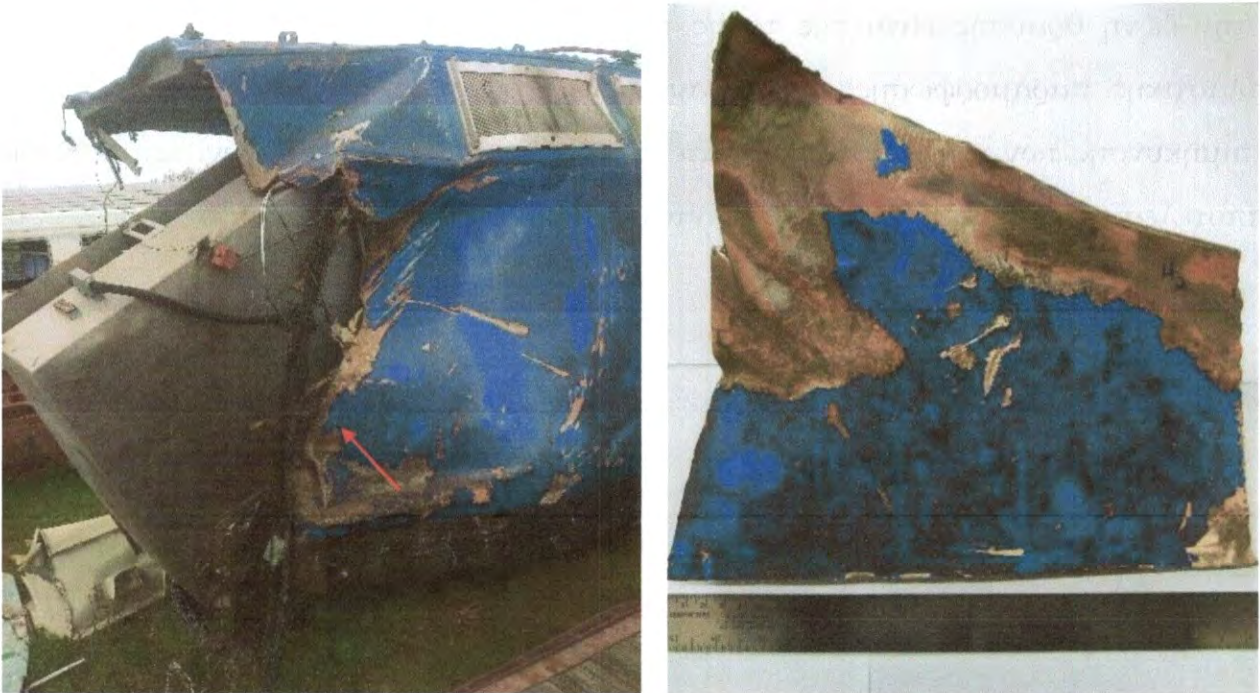
Εικόνα 20: Δείγμα "H2" (Ηλεκτράμαξα 2), από το πίσω και δεξιά τμήμα της αποκόλλησης
