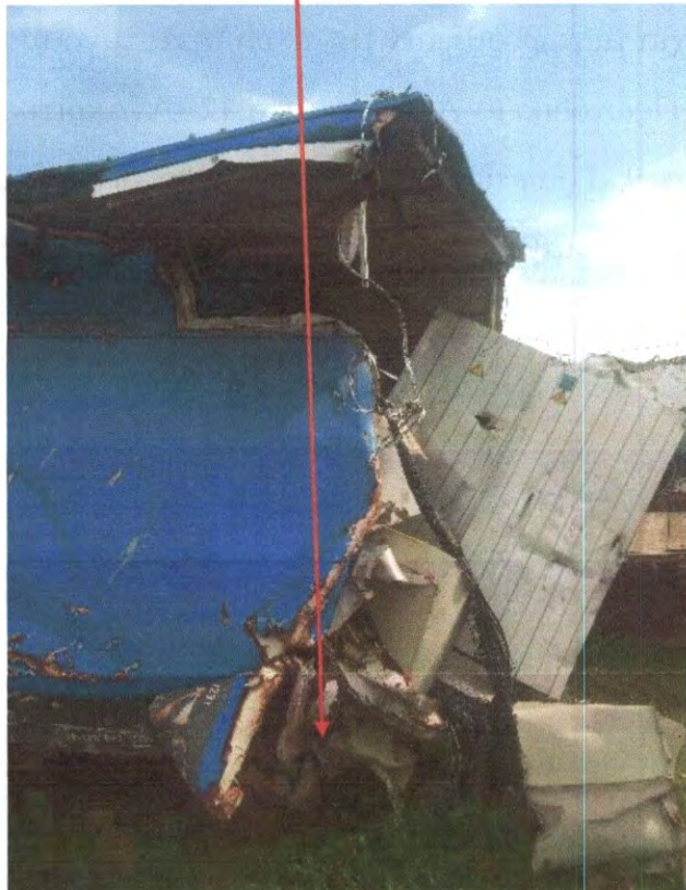
Εικόνα 12: Δείγμα "H3" (Ηλεκτράμαξα 3), από το πίσω και κάτω αριστερά τμήμα της Ηλεκτράμαξας, και αντίστοιχο Δείγμα "K5" (Κόκπιτ 5), τα οποία έχουν αποκοπεί πιθανότατα με οξυακετυλινική κοπή
