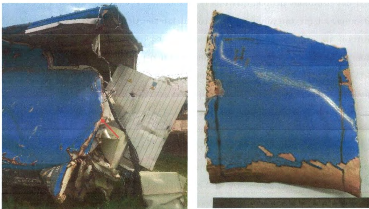
Εικόνα 13: Δείγμα “H1” (Ηλεκτράμαξα 1), από το πίσω και αριστερά τμήμα της αποκόλλησης
