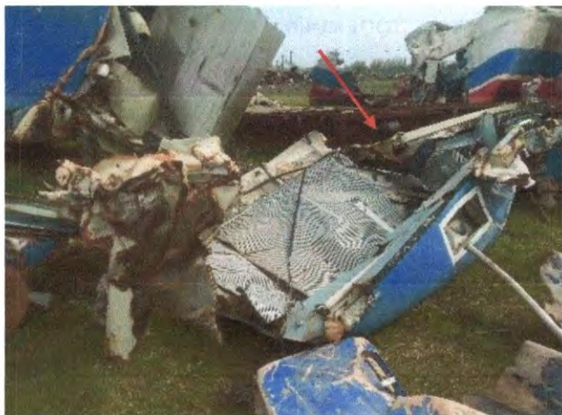
Εικόνα 27: Δείγμα “Κ1α” (Κόκπιτ 1α) από την αριστερή πλευρά Οροφής του Θαλάμου Μηχανοδήγησης
