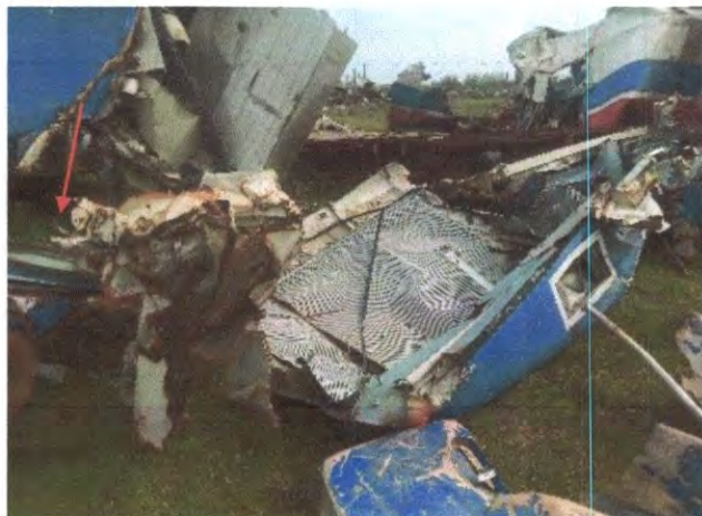
Εικόνα 34: Δείγμα “Κ1β” (Κόκπιτ 1β) από την δεξιά πλευρά της οροφής του Θαλάμου Μηχανοδήγησης
