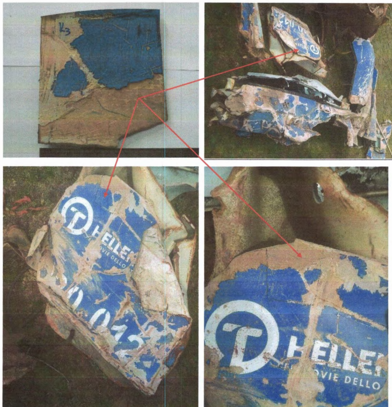
Εικόνα 10: Δείγμα "Κ3" (Κόκπιτ ) από το εμπρόσθιο τμήμα του Θαλάμου Μηχανοδήγησης, με το λογότυπο της εταιρείας και τον αριθμό της Ηλεκτρομηχανής (120 012)
